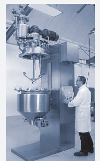
Der EKATO SOLIDMIX VPT 50 zur Trocknung pharmazeutischer Wirkstoffe (API).
