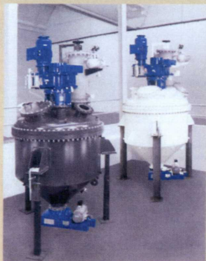
BU: мешалка SOLIDMIX, тип SOLIDMIX VSM 2500
