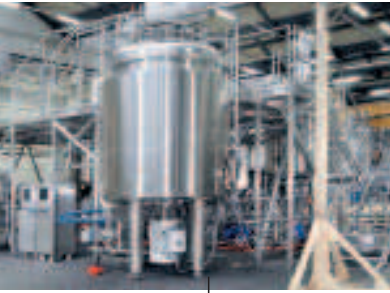
Universalmaschine für einen international tätigen Kosmetikhersteller mit über 5.000 l Chargenvolumen
