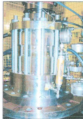
Test unter realen Bedingungen: Die neue ESD-Gleitringdichtung hält einem Behälterdruck bis 200 bar und Temperaturen bis 300 °C mühelos stand
